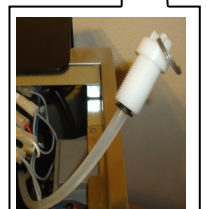
Ablassventil am Karbonator-Kessel für einfache Reinigung
